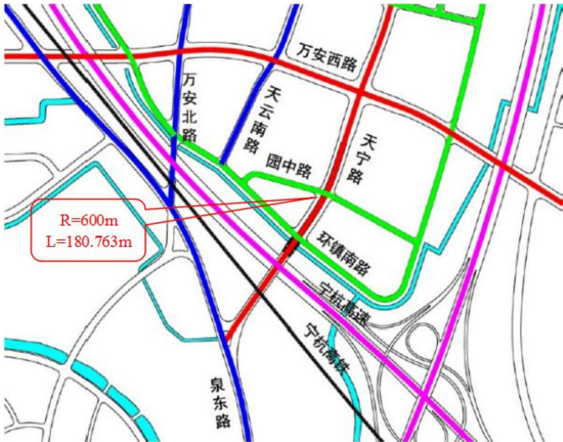
图 1-3 润麒路跨线桥道路平面简图
