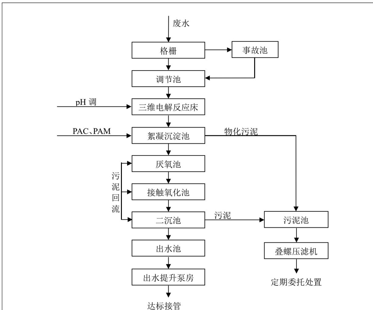
图 8-1 本项目实验室污水预处理工艺流程图
