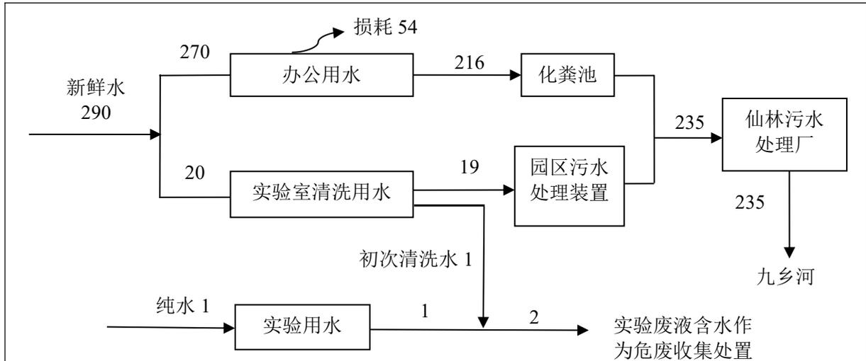
图 6-1 建设项目用水平衡图 (t/a)
