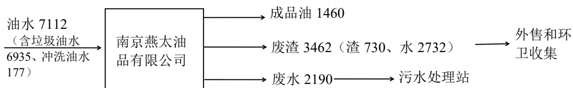
图 4.2-3 本项目油水混合物进南京燕太油品有限公司物料平衡图 (t/a)
