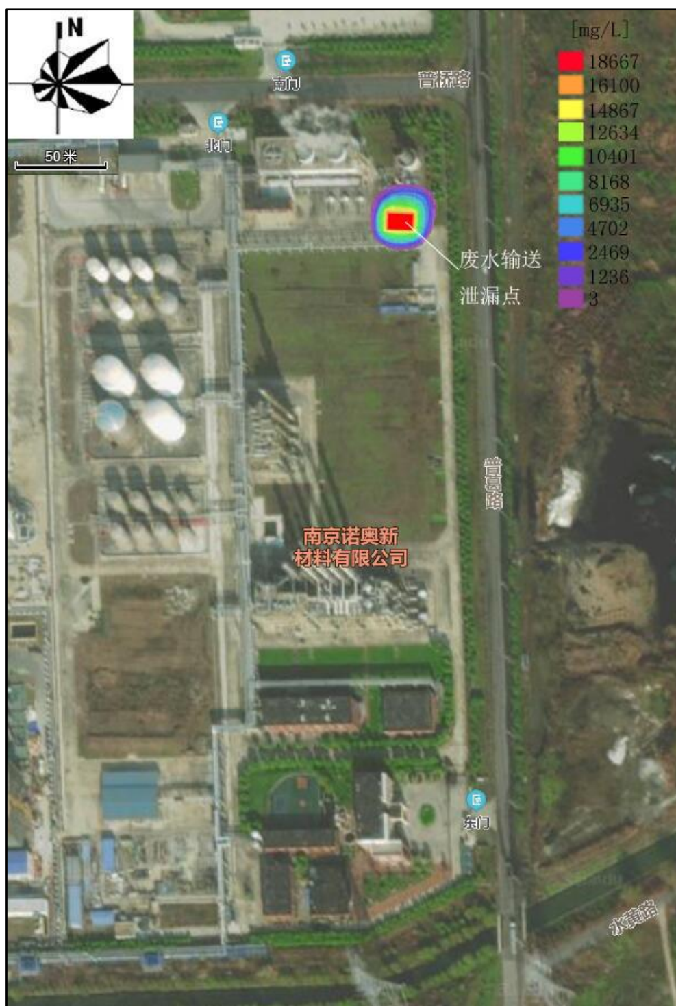
图6.2-21 事故废水输送管线泄漏100天 \text{COD}_{\text{Mn}} 的运移范围图
