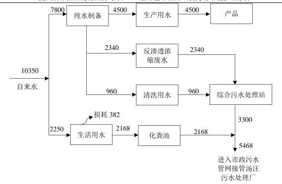
图 2.9-2 变动后项目用排水平衡图 (单位:吨/年)
