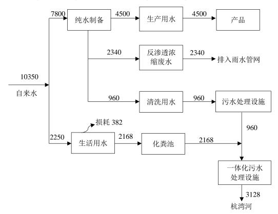
图 2.9-1 变动前项目用排水平衡图 (单位:吨/年)
